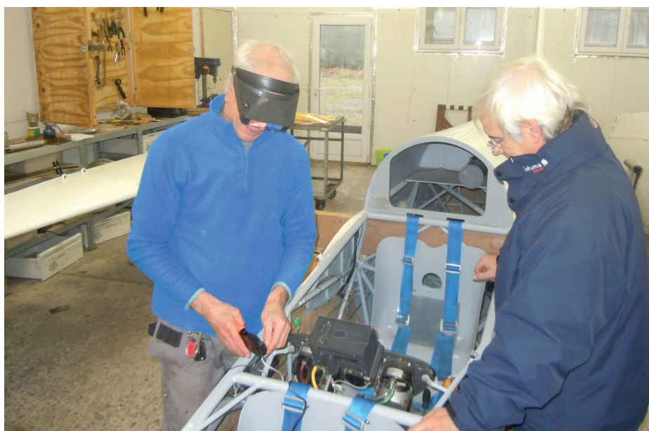
Jan en Luc installeren de Kobo moving map in de ASK13
